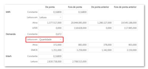
A unidade consumidora deve estar configurada desta forma, pois a demanda reflete a capacidade máxima de potência elétrica que um consumidor exige da rede elétrica em um determinado período, e não a quantidade total de energia consumida em kWh.
